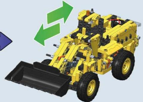
**Trazione manuale:** muovi il modello manualmente. Tira indietro l'astina 5 e bloccala con la barra singola 3 fori, come in figura. In questo modo il pignone non è più accoppiato alla corona del differenziale e le ruote posteriori possono muoversi liberamente. Utilizza la barra che sporge dalla cabina per sterzare.
