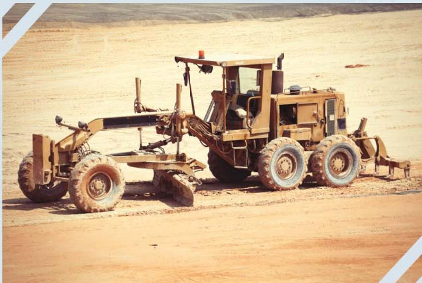
Una motolivellatrice, chiamata anche “grader”, è una macchina capace di spostare, scavare e soprattutto livellare il materiale terroso.
