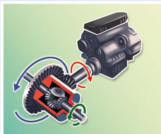
La base del telaio posteriore che hai appena costruito, monta un differenziale completo di pignone, che ci permetterà in seguito di trasferire il movimento dal motore elettrico alle ruote.
