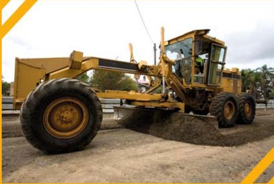
La lama può essere direzionata dall'operatore, così da permettere alla macchina di spostare eventuale materiale accumulato. L'altezza da terra e l'inclinazione sono regolate tramite due cilindri idraulici collegati al braccio della lama.
