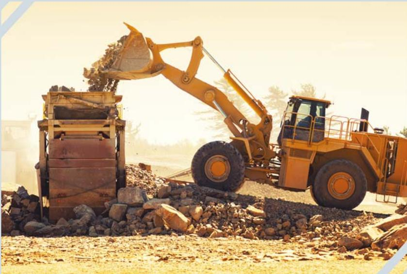
La Pala caricatrice è una macchina movimento terra utilizzata per il carico e il trasporto di materiale terroso.
