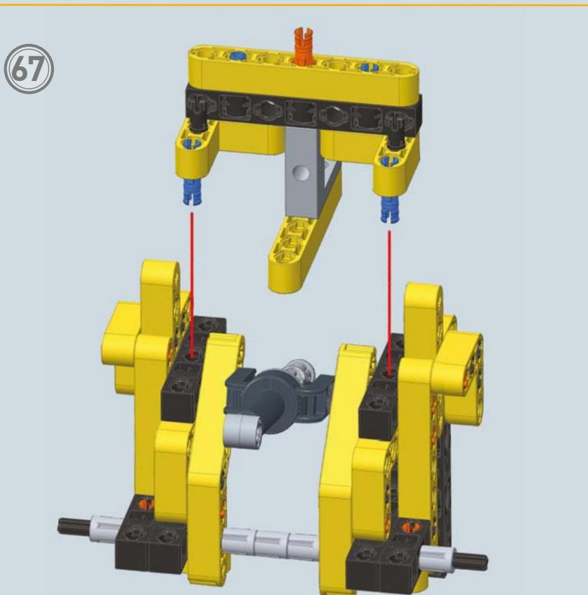
Unisci la parte inferiore e superiore del telaio, allineando la forcella del giunto con il foro del modulo di trasmissione.
