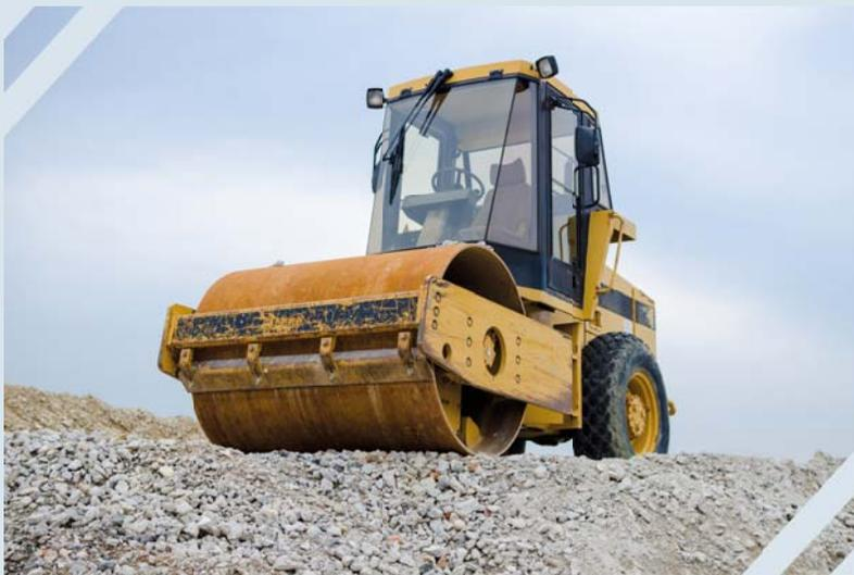
Il rullo compressore (o compattatore), è una macchina utilizzata in cantieri edili e in cantieri stradali, per la compattazione del terreno o del manto bituminoso.
