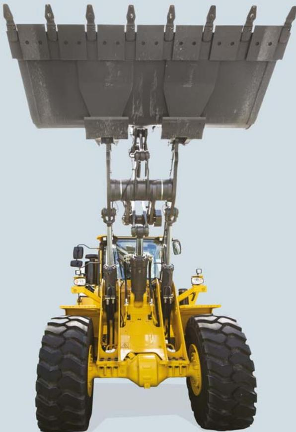
L'elemento caratterizzante del mezzo è proprio la pala anteriore, detta benna, la cui capacità di carico va da circa 1 m<sup>3</sup>, per i modelli più piccoli, a circa 25 m<sup>3</sup> per le versioni più grandi. La pala è connessa al telaio tramite due bracci movimentati da cilindri idraulici.
